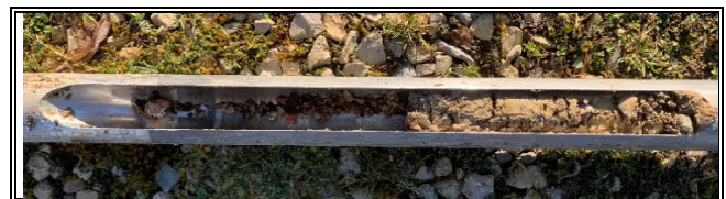
Bohrung KRB 3, 3,5 - 4,0 m, Wasserzutritt
